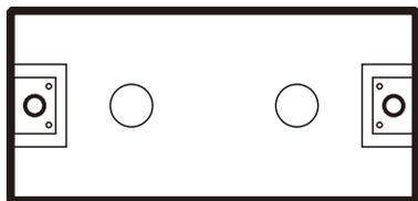
第二步: 拔出主机背面橙色卡子, 接好线路, 卡回对应孔位, 绿色为电源接口.
